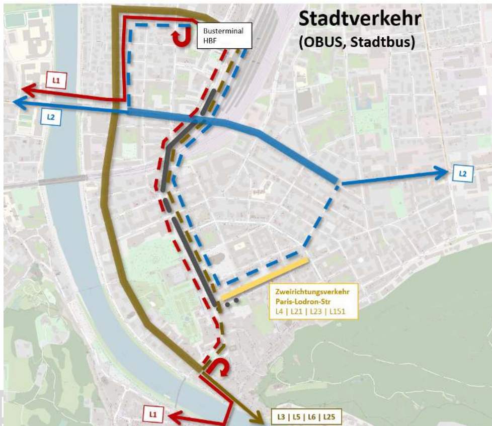
Abbildung 2: S-LINK | Bauphase | Geänderte Linienführungen ÖV-Stadtverkehr - Prinzipskizze
