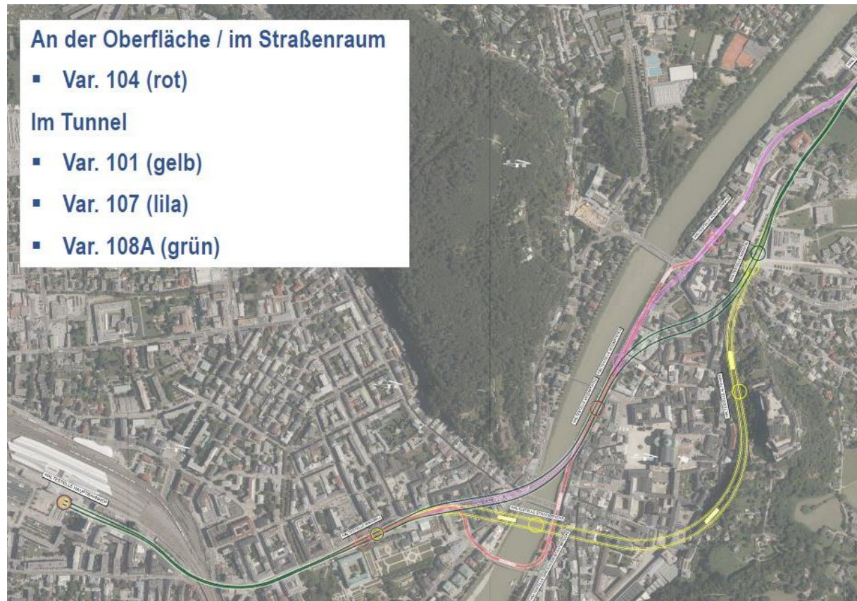
Abb.1: S-Link Trassenvarianten für Wirkungsanalyse
